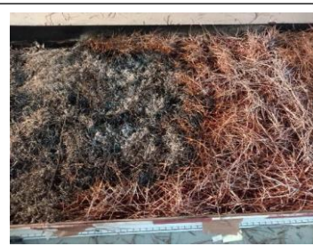
Εικόνα 2. Η φωτιά σταμάτησε με την χρήση 1.5 l/m 2 PREFIREX , 24 ώρες μετά τον ψεκασμό.
