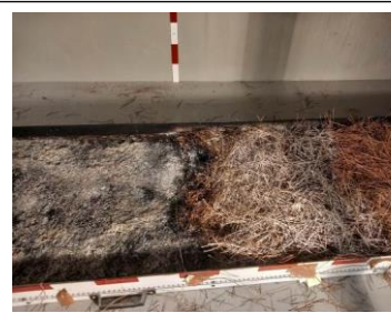
Εικόνα 1. Η φωτιά σταμάτησε με την χρήση 1.5 l/m 2 PREFIREX , 1 ώρα μετά τον ψεκασμό.
